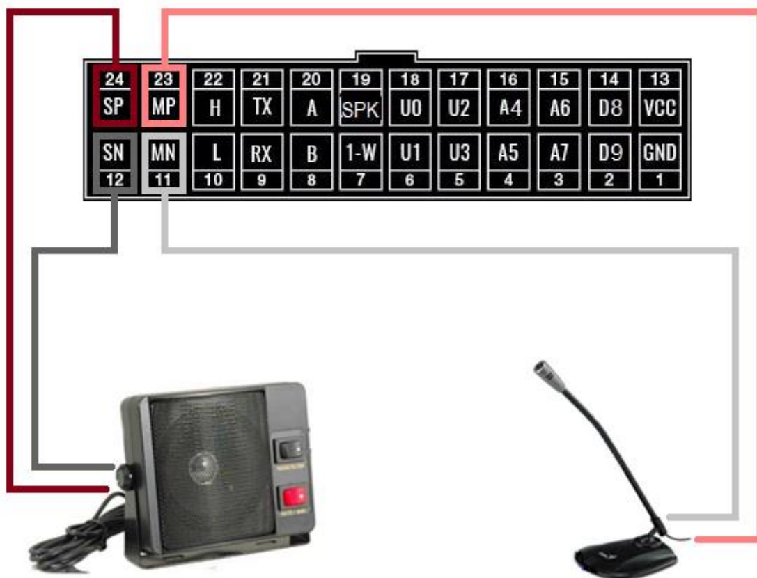
Рисунок 23 – Схема подключения микрофона и динамика
